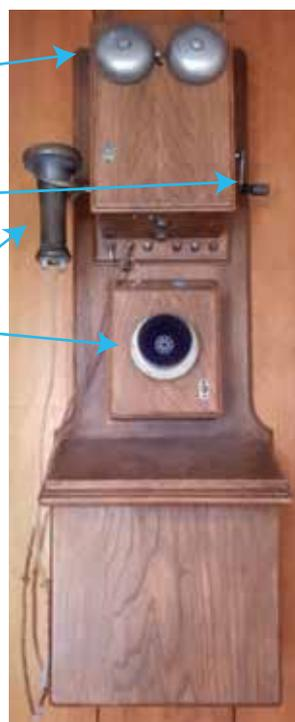
ソリッドバック磁石式壁掛電話機
